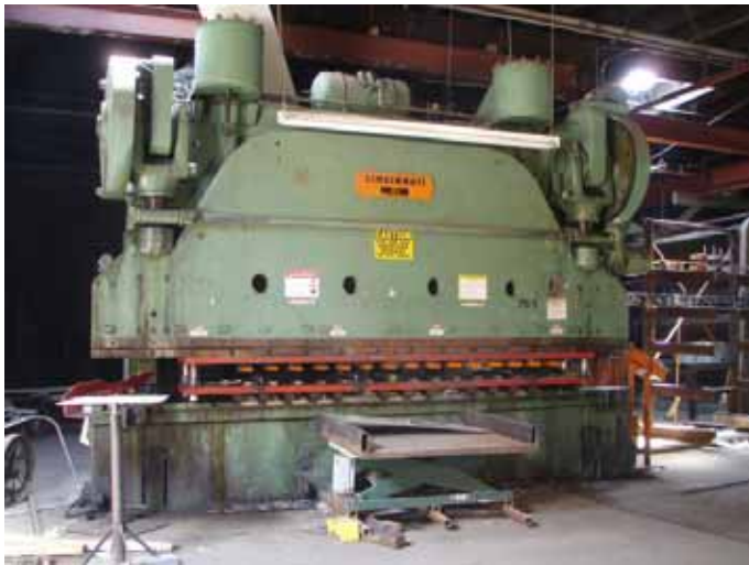
Press Brake, Cincinnati 21, s/n 33364, 12', 600 ton
